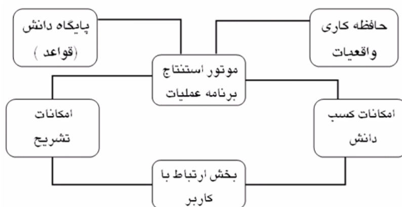
شکل ۳- ساختار یک سیستم خبره مبتنی بر قاعده
